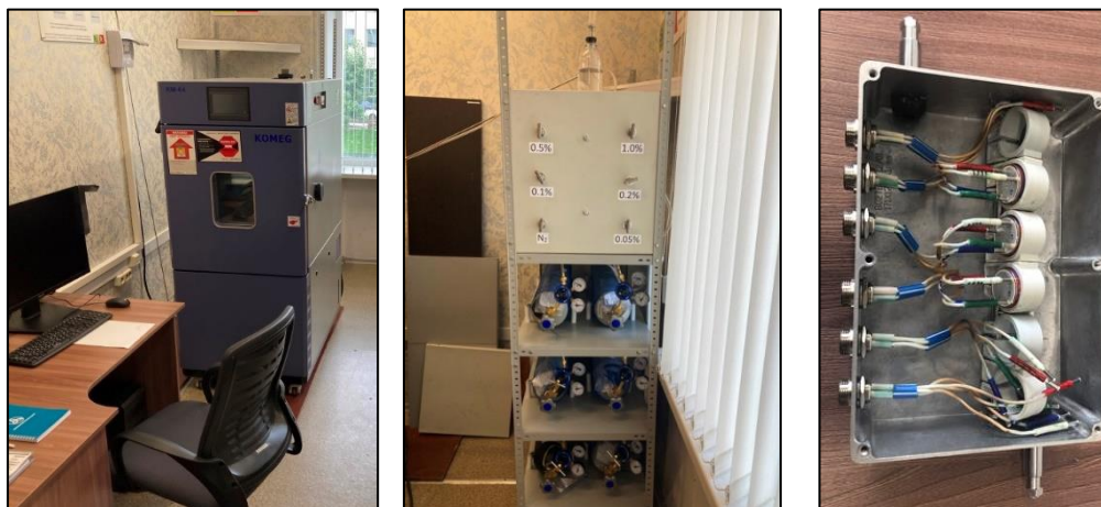
Рисунок 3 – Тестирование и калибровка сенсоров метана (климатическая камера диапазон температур: -70 \div +150^{\circ}\text{C} – левое окно; газовая станция – центральное окно; одновременное тестирование до 6 сенсоров – правое окно).
